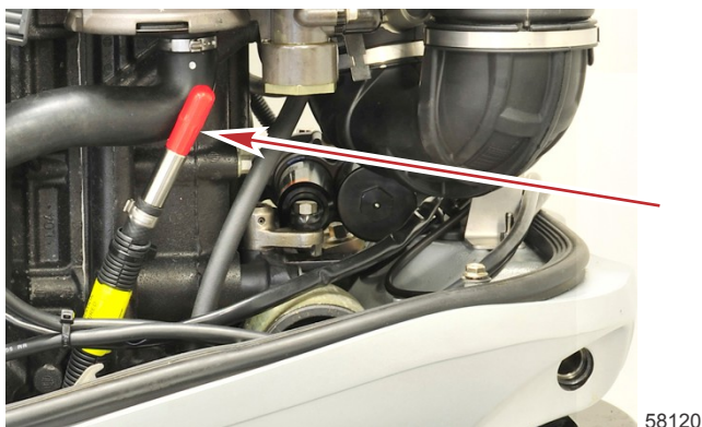
Расположение впускного топливного шланга
